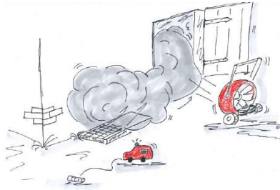
Abbildung 16 Zu- und Abluftöffnung liegen zu nah beieinander. Austretender Brandrauch wird wieder vom Lüfter ins Gebäude gedrückt. [IdF NRW]
