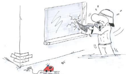
Abbildung 22 Abluftöffnungen können von außen gewaltsam geschaffen werden. [IdF NRW]
