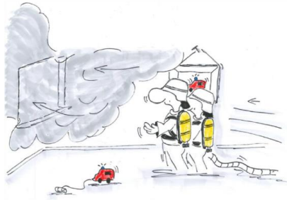
Abbildung 10 Vorteile der Ventilation zur Unterstützung des Innenangriffs [IdF NRW]
