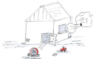
Abbildung 23 Starke Windlast auf der Abluftöffnung kann eine gezielte Ventilation verhindern. [IdF NRW]
