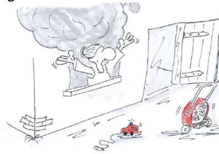
Abbildung 21 In der Abluftöffnung dürfen sich keine Personen aufhalten. [IdF NRW]
