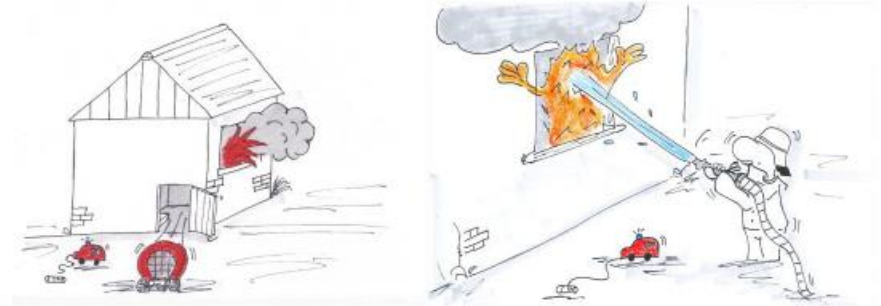
Abbildung 24 Die Abluftöffnung ist zu kontrollieren. [IdF NRW]
