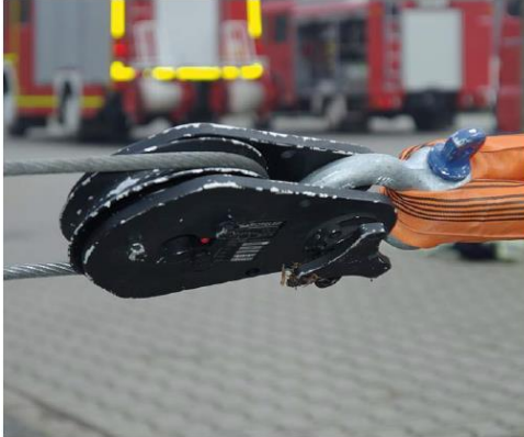
Einsatz einer losen Rolle
