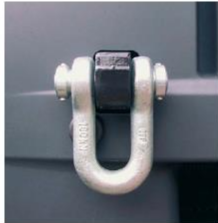
Festpunkt am Feuerwehrfahrzeug (160 kN)
