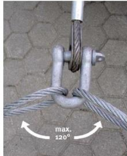
Maximum: Der Seilspreizwinkel beträgt 120 °.
