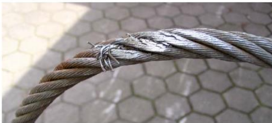
Dieses Stahldrahtseil ist ablegereif!
