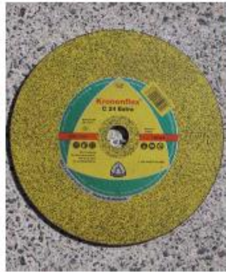
Trennschleifscheibe für erhöhte Umfangsgeschwindigkeit mit rotem Farbsreifen
