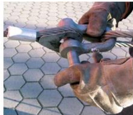
Zugseile und Anschlagseile nur mittels Schäkel verbinden.
