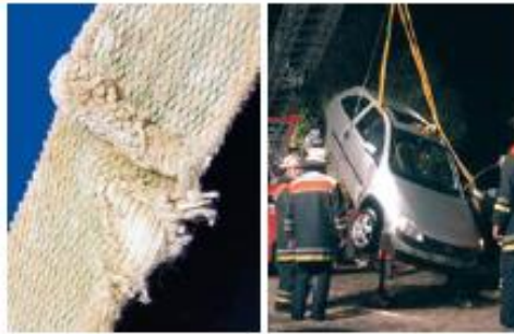
Dieses Hebebänder ist ablegereif!
