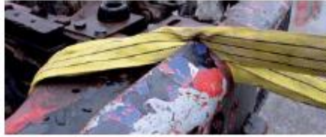
Vorsicht! Hebebänder nicht über scharfe Kanten spannen.
