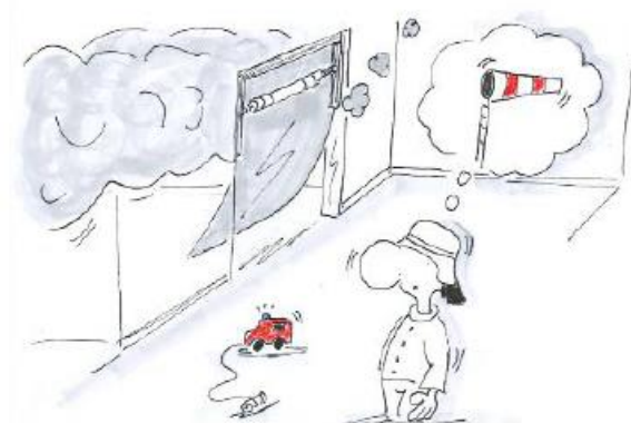
Abbildung 26 Neben der Ventilation verhindert der mobile Rauchverschluss ein unkontrolliertes Ausbreiten von Rauch im Gebäude. [IdF NRW]
