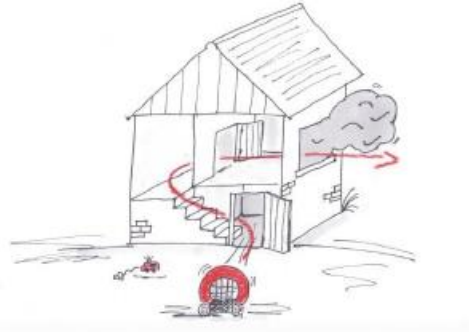
Abbildung 25 Der Ventilationskanal wird vom vorgehenden Trupp festgelegt und kontrolliert. [IdF NRW]
