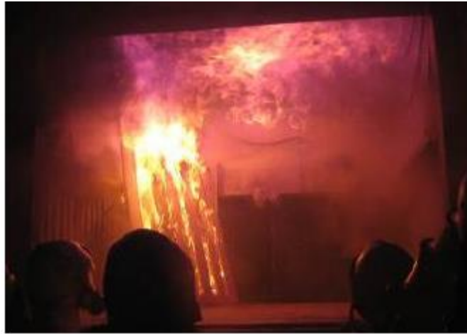
Abbildung 3: Entwicklungsphase dargestellt in Übungsanlage: sichtbaren Pyrolysegase auf der rechten Seite. (Foto: Fuchs, ecomed-Storck GmbH)
