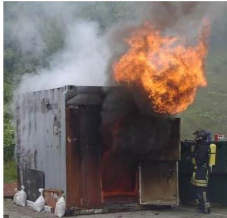
Abbildung 13: Die Temperatur der Pyrolysegase ist so hoch, dass sie sich an der Tür sofort bei Sauerstoffzutritt selbst entzünden (Selbstentzündung der Brandgase). (Foto: Fuchs, Wuppertal, ecomed-Storck GmbH)
