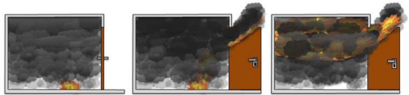
Abbildung 20: Ablauf der Selbstentzündung heißer Pyrolysegase nach dem Öffnen einer Tür. (Grafik: Andreas Weich)
