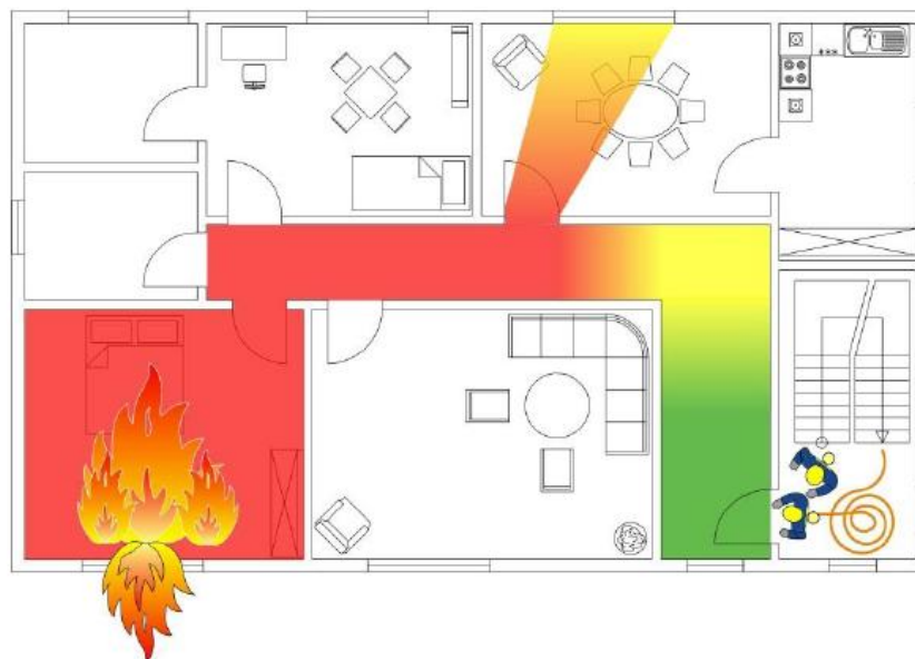
Abbildung 22 - Negative Verschiebung der Gefahrenbereiche bei offener Brandraumtür und offenem Fenster als Ventilationsöffnung sowie zusätzlichem Strömungspfad durch weitere Ventilationsöffnung. (Auch das Öffnen der Tür zur Nutzungseinheit (Strömungspfad!) kann eine negative Verschiebung der Gefahrenbereiche bewirken!), Jürgen Buil
