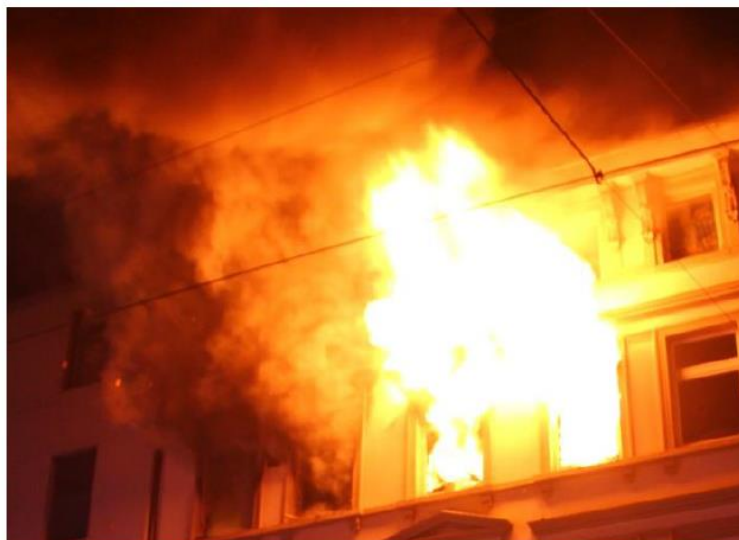
Abbildung 8 - alle Fenster sind flächig mit Flammen ausgefüllt, so dass der notwendige Sauerstoff von einer anderen Zuluftquelle kommen muss, Quelle: ecomed-Storck GmbH
