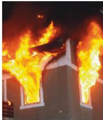
Abbildung 8 - alle Fenster sind flächig mit Flammen ausgefüllt, so dass der notwendige Sauerstoff von einer anderen Zuluftquelle kommen muss, Quelle: ecomed-Storck GmbH
